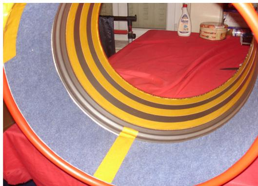
Cette isolation est facultative et dépend du résultat sonore que l'on désire. En l'absence de cet isolant, la résonance du tube sera plus longue et plus métallique. On oubliera pas de percer un petit trou d'environ 8 mm dans le bidon, pour la décompression. D'autres matériaux que la moquette peuvent être utilisés. Chacun fera selon ses disponibilités. L'avantage de la moquette est de bien se tenir, collée à du double face.
