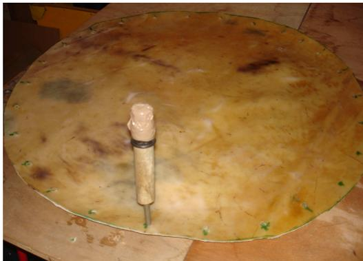
L'outil permet de percer des trous ronds, qui se déchirent moins facilement que les trous obtenus avec un couteau ou une lame de rasoir. L'outil maison est réalisé avec un petit tube en aluminium ou fer blanc, coupé en biseau et limé. Cet outil de fortune remplacera avantageusement un poinçon de cordonnier. Il peut aussi servir pour les peaux de jembé. Un manche en bois a été ajouté au tube, afin de ménager nos mains.
